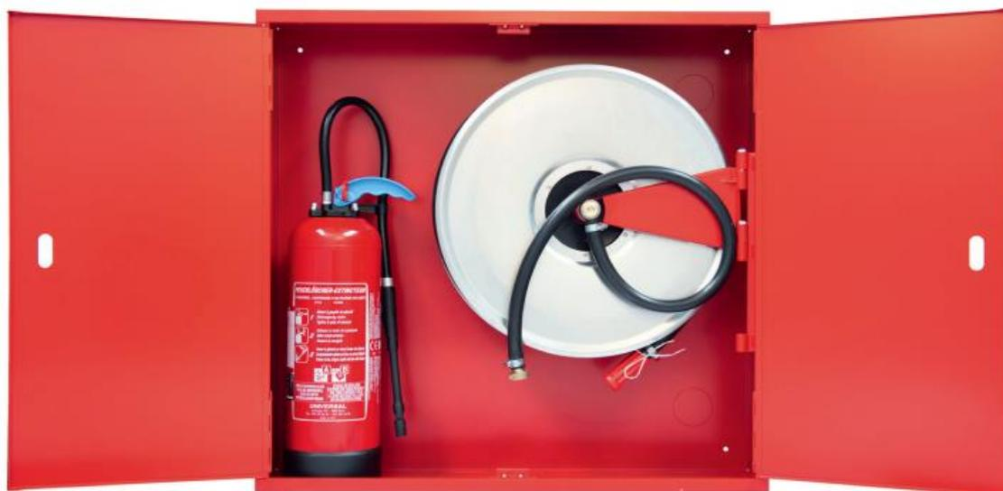
Boîtier en tôle d'acier, gris (NCS S 2502 B) ou rouge (RAL 3000 rouge feu) revêtement poudré, 2 portes, place pour un extincteur à côté du dévidoir. Disques de dévidoir en aluminium Ø 56cm, profondeur 22cm avec tambour en plastique, tuyau noir Ø 19/27mm, connexion pour le tuyau de raccordement 1" filetage intérieur, lance à jet creux PICCOJET avec embout intégré, prix sans vanne d'incendie.
